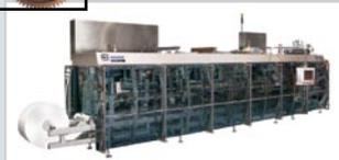
Термоформовочные машины Ойстар Хассия (Oystar HASSIA) – автоматическое фасовочное оборудование полного цикла с формированием упаковки из пластика, например полистирола и полипропилена, в том числе цветного и прозрачного, последующими наполнением,
