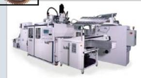
Формовочные автоматы ИЛЛИГ RDM К предназначены для изготовления полимерной тары (стаканы, контейнеры и т.п.) и фасования в нее жидких и пастообразных продуктов (йогурты, творожки, пудинги, сливки, сыры плавленые и т.п.) с последующим запечатыванием
