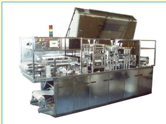
Фирмой «Рекупер» создана новая автоматическая линия фасовки и блистерной упаковки пастообразных пищевых продуктов. Пилотный образец автомата АЛБ 360 в настоящее время проходит производственные испытания, после которых автомат будет поставлен на серийное производство.
