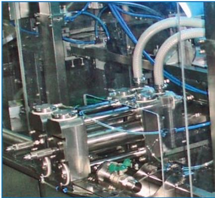
Рис. 2. Дозатор, работающий по схеме Direct Filling
